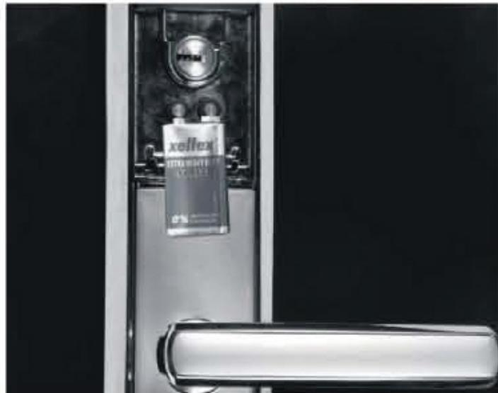
Khi mức nước khóa phát ra 3 tiếng “beep” cùng với đèn LED màu vàng và màu xanh lá cây nhấp nháy, báo hiệu pin yếu. Nên thay pin càng sớm càng tốt.
